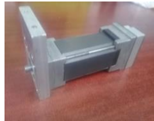
Fig. 11. Motor BLDC DMA0204024B101, marca Microchip.
